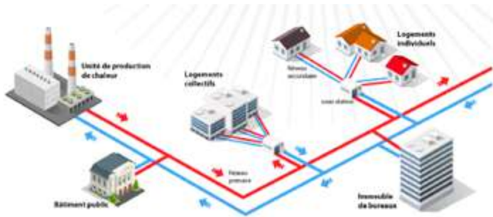
Fig. 1. Schéma de principe d'un Réseau de Chaleur
