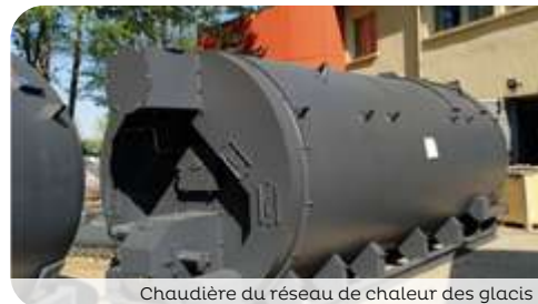
Chaudière du réseau de chaleur des glaciés
